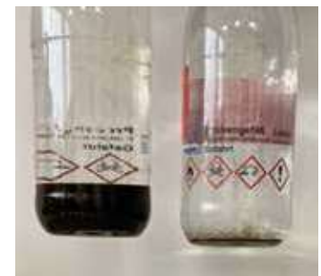
Auf diesem Bild ist der Unterschied von Beginn und Ende des Spülverfahrens anhand der abgesetzten Proben ersichtlich.
